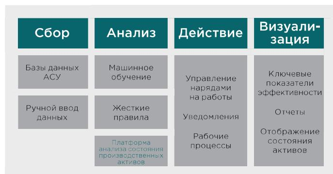
**Avantis PRiSM интегрируется с существующими системами сбора данных и может быть объединен с Avantis Condition Manager для создания промышленной аналитической платформы всеобъемлющего управления эффективностью оборудования.**
