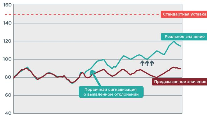
Avantis PRiSM упрощает выявление аномалий в работе оборудования и сигнализирует об отклонении от нормального состояния раньше существующих систем
